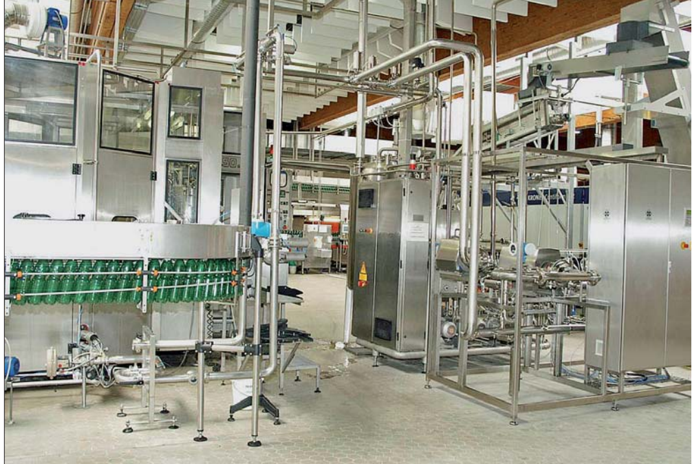
15 000 PET-Flaschen (0,5 l) schafft die Abfüll-Linie – durch den Einsatz der beiden parallelen Cavitoren (rechts im Vordergrund) wird dieser Wert nun auch bei der Abfüllung von Süßgetränken wieder erreicht.
